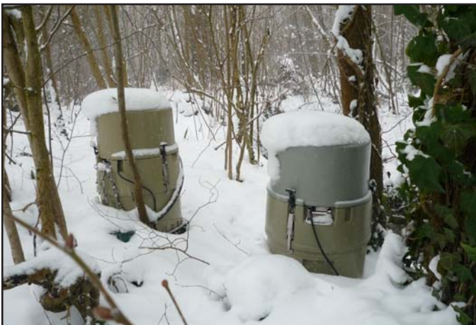
Photographie 5 : Préleveurs automatiques sur le ruisseau de l'Eau Brillante, juste en aval du rejet du trop plein de la source de l'Eau Brillante
